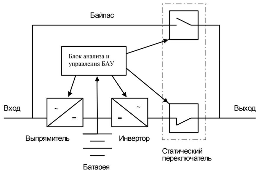
Рисунок 4 – Блок-схема УБП с двойным преобразованием энергии
