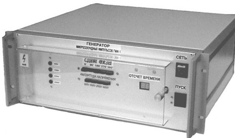
Рисунок 1 – Генератор микросекундных импульсов ГМИ-1
