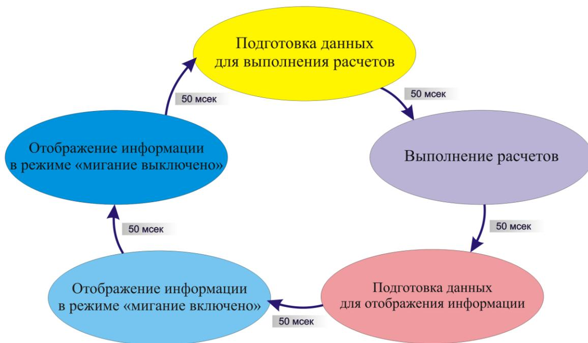
Рисунок 3 - Циклограмма синхронизации компонент по отображению информации
