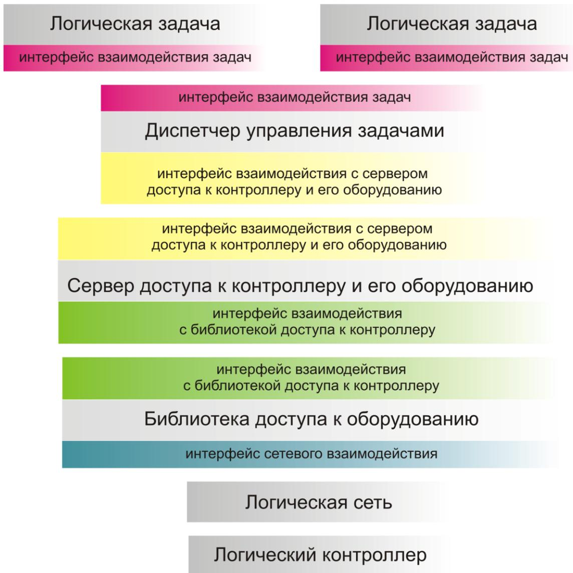
Рисунок 2 - Структура взаимодействия программных компонент
