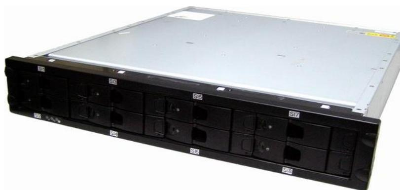
Рисунок 7 – Модуль дисковых накопителей резервированных ПС5120
